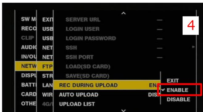
REC DURING UPLOAD項目をENABLEに設定
