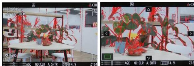
ピントが合っている箇所の輪郭を強調します。強調表示の強弱や色の変更ができます。右図のように拡大表示した映像にピーキングを付加することも可能です。
