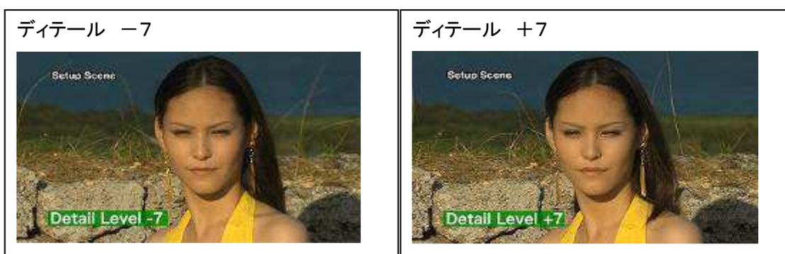
AG-AC90 ではディテール(水平垂直両方向)とVディテール(垂直方向)を組み合わせることで、一定の輪郭信号レベルの範囲の中で、水平・垂直両方向のバランスをとりながら調整することができます。
