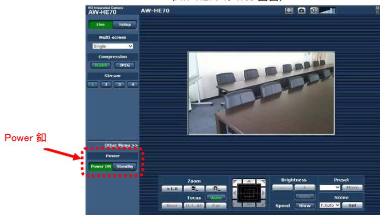
AW-HE70 の電源状態が STANDBY モード(電源 OFF: 工場出荷時)の場合は、[Power ON]鈕で電源 ON にしてください。
