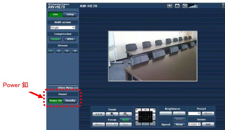
AW-HE70 の電源状態が STANDBY モード(電源 OFF:工場出荷時)の場合は、[Power ON]釦で電源 ON にしてください。
