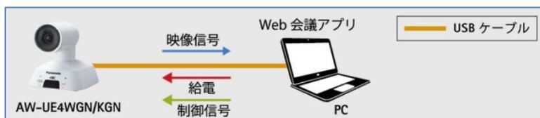
パソコンから USB ケーブル経由で給電が可能です。本機に AC アダプターを接続せず運用することができ、映像伝送、制御信号(\*1)、電源供給(\*2)をケーブル 1 本で実現します。
