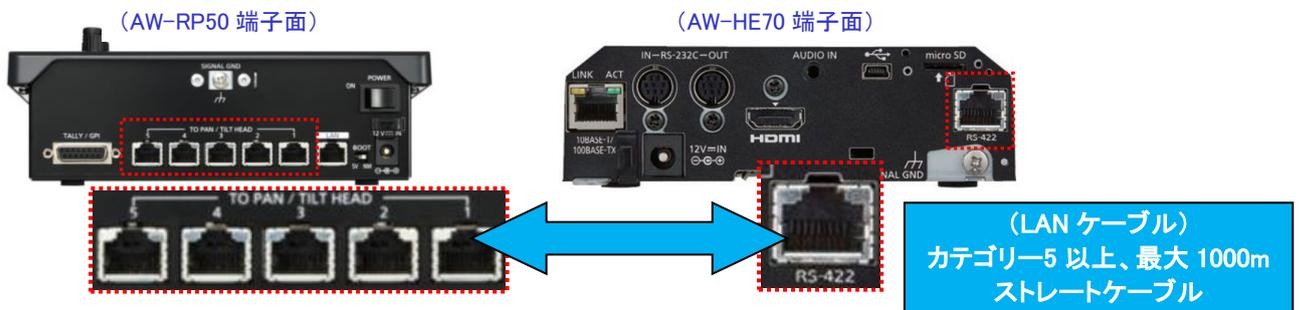
※TO PAN/TILT HEAD 端子の[1]~[5]は、AW-RP50 の接続設定「CAM1」~「CAM5」に対応しています。
