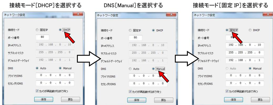
3. IP アドレス変更後、[保存]ボタンをクリックする。「カメラの設定が完了しました。」と表示されれば変更完了です。
