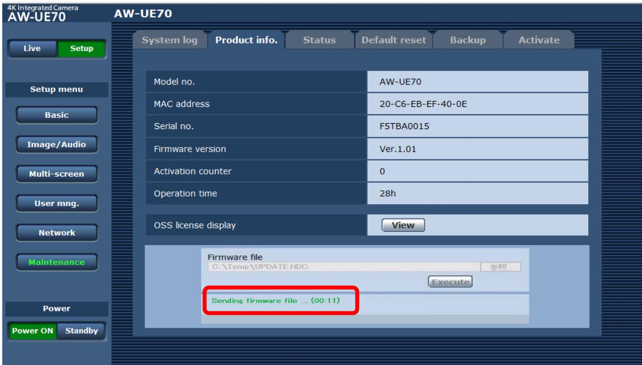
10. ファームウェアのカメラへの転送が完了すると、アップデートが開始され、進捗状況が表示されます。
