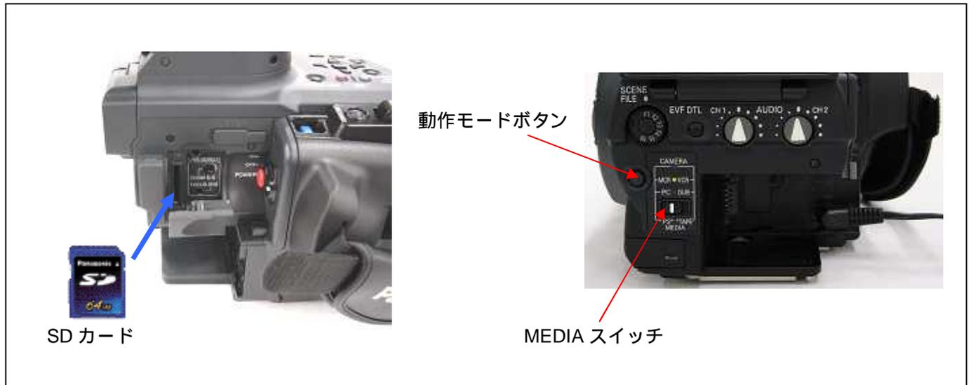
2. 動作モードボタンを押して、本機を P2-MCR モードにします。
