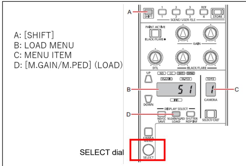
4. [SELECT] ダイアルを操作し、**"y"** を選択。[SELECT] ダイアルを押しアップデートを開始します。
