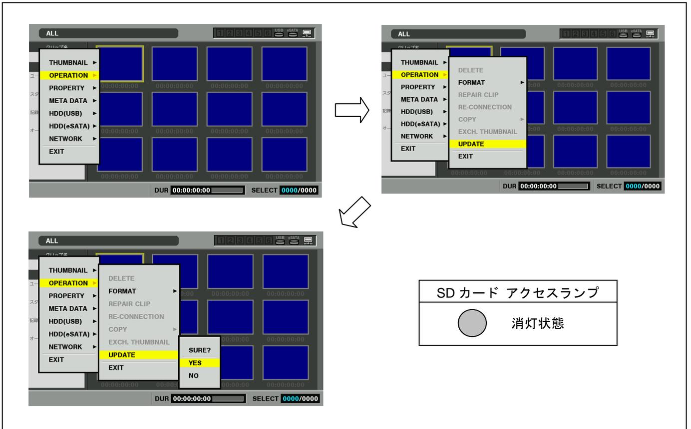
4. アップデート処理が開始され、画面に“PREPARING FOR UPDATE”のメッセージが表示されます。この時点ではアップデートのデータの確認などの準備を行っています。SDメモリーカードのアクセスランプは消灯状態です。
