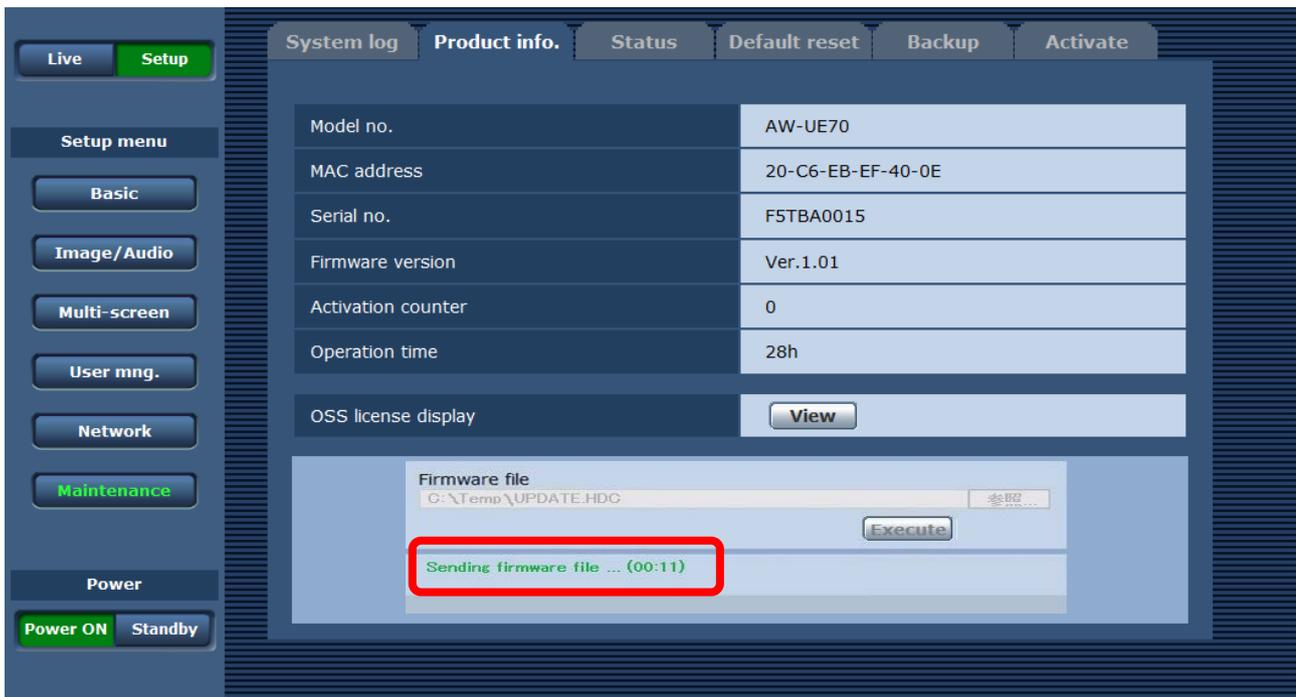
10. ファームウェアのカメラへの転送が完了すると、アップデートが開始され、進捗状況が表示されます。
