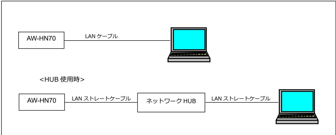
本機の IP 制御用 LAN 端子と PC を、スイッチング HUB などを介して接続する場合は LAN ストレートケーブルを使用します。
