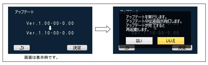
アップデートが開始されると LCD 画面にはなにも表示されなくなり、**状態表示ランプ**が消灯します。アップデート中、状態表示ランプは消灯した状態のままになります。
