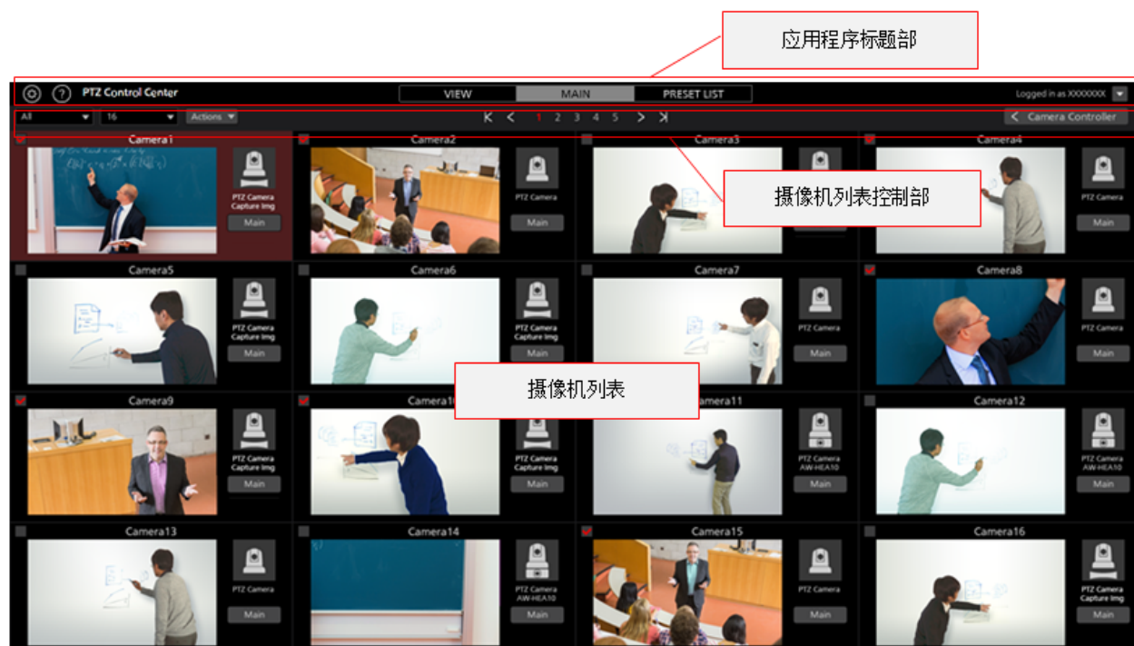
查看屏幕（摄像机控制器显示器关闭）
