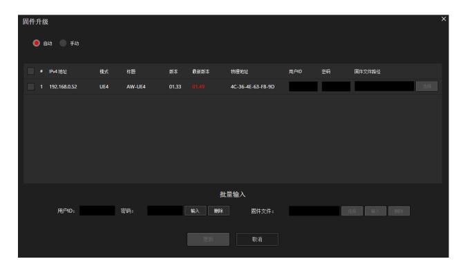
从下载固件文件到对遥控摄像机进行版本升级,所有的操作都由应用程序来完成。 摄像机列表中只显示需要将其固件升级到最新版本的遥控摄像机。
