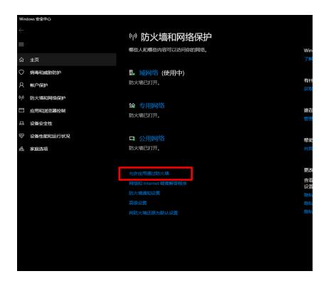
3. 对于允许的应用程序列表中的 easyipconfig.exe , 请检查摄像机所连接的网络。
