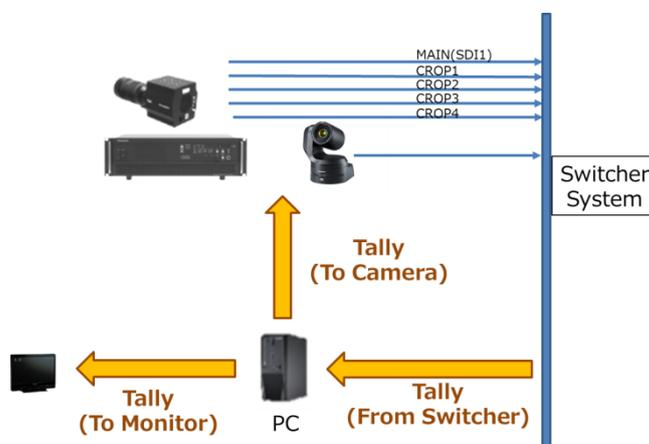
如下图中所示，计数设定中可以进行用于从切换台接收计数信息的 I/F 和协议的设定、用于向图像显示器发送计数信息的 I/F 和协议的设定。
