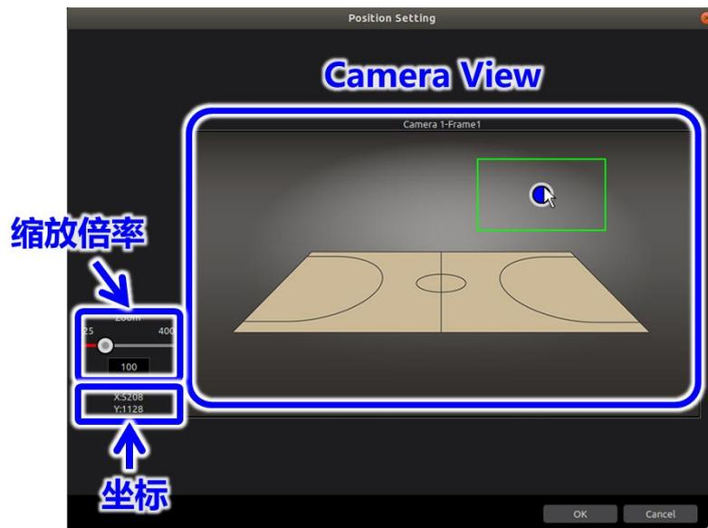
在位置固定设定中，可以通过在 Camera View 画面中单击鼠标来设定裁剪框的位置。此时，将裁剪框的中心位置作为 8K 视角（7680x4320）显示在坐标栏中。
