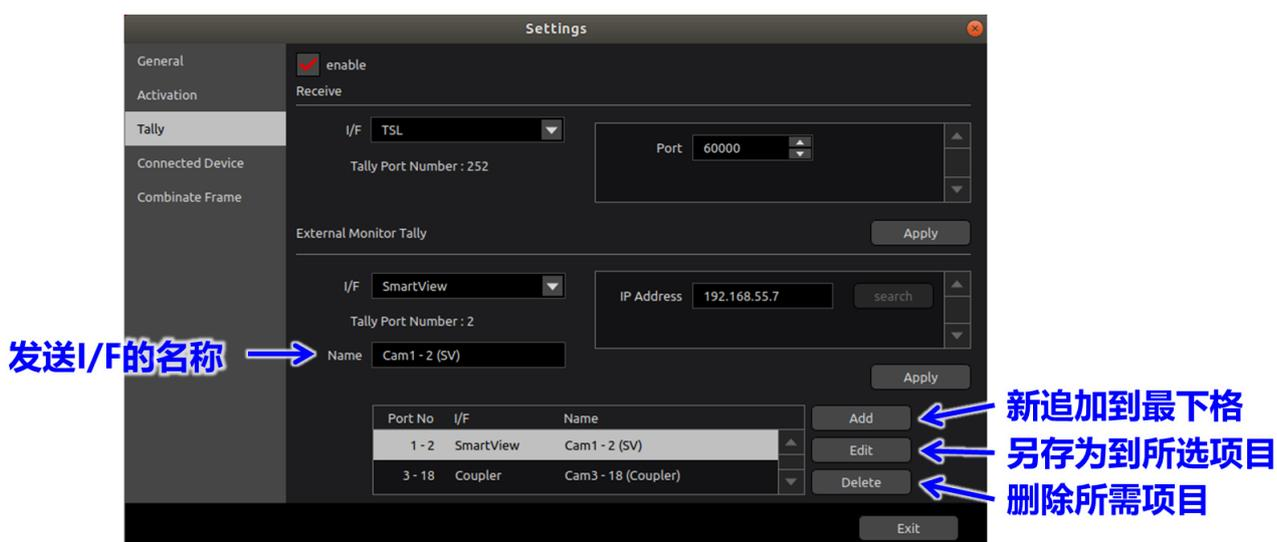
可以在连接设备设定中，将此处设定的接收 I/F 以及发送 I/F 的端口数分配到裁剪框中。另外，在连接设备设定中进行裁剪框分配设定后，即使再次进行接收 I/F 的设定或发送 I/F 的设定，也无法追踪分配到裁剪框的端口号。
