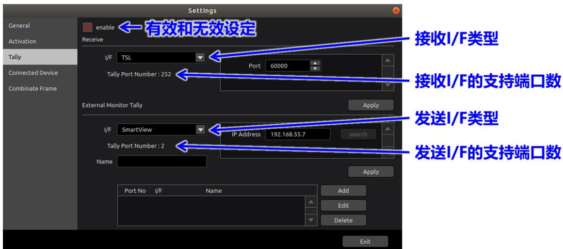
有效或无效设定中可以使用或设定 Tally 功能。通过勾选选框，可以选择接收 I/F 类型、选择发送 I/F 类型。虽然接收 I/F 类型预计以后会扩展，但是目前只有[Coupler]以及[TSL]。从组合框中选择接收 I/F 类型并进行设定。按下应用(Apply)按钮后，将显示该接收 I/F 所支持的端口数。此外，由于发信源的切换台只设想为一台，所以按下应用(Apply)按钮后，之前的接收 I/F 的设定将变为无效。
