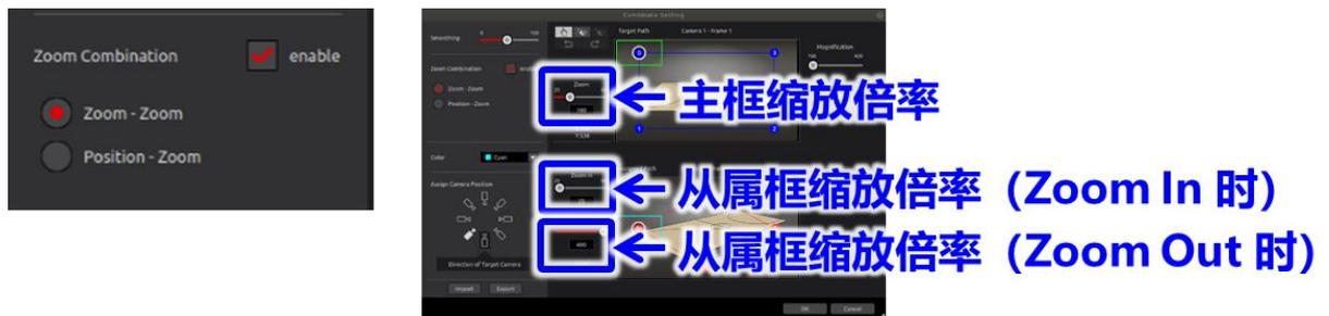
与主框位置联动并且想使从属框的缩放动作联动时，如下图所示，请勾选“enable”选框，并选择“Position - Zoom”。将会显示可设定从属框缩放倍率的滑动条。可以通过操作滑动条来变更从属框的缩放倍率。该缩放倍率可在每个从属框位置进行设定，并可以根据从属框的位置改变缩放倍率。
