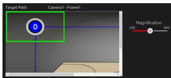
在移动流畅度设定中，可以设定从属框的移动平滑度。值越大移动越平滑。
