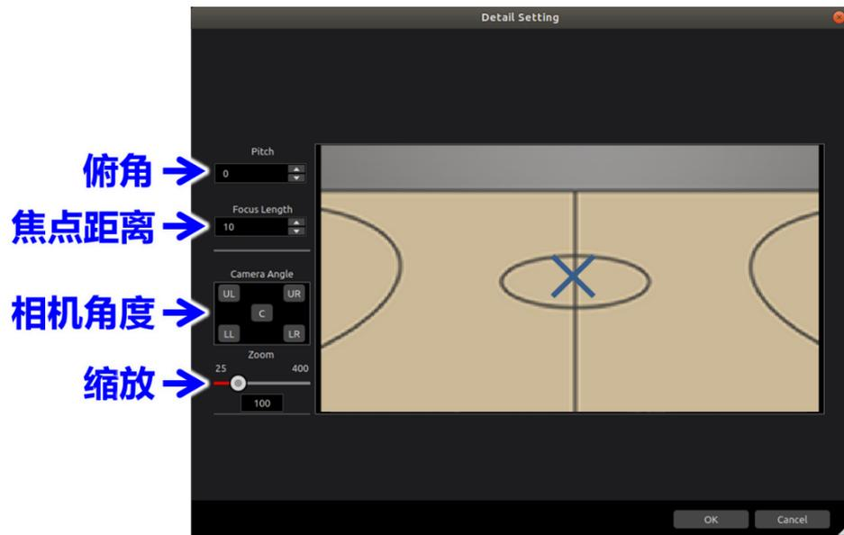
打开设定画面后，如果远程相机连接，则会显示捕获图像。此外，图像的中央会出现便于确认中心位置的x标记。在俯角(Pitch)、焦点距离(Focus Length)的设定中，对8K相机中的裁剪框抓拍远程相机时的8K相机的俯角和焦点距离进行设定。此外，相机角度(Camera Angle)也同样会指定8K视角中的拍摄位置。
