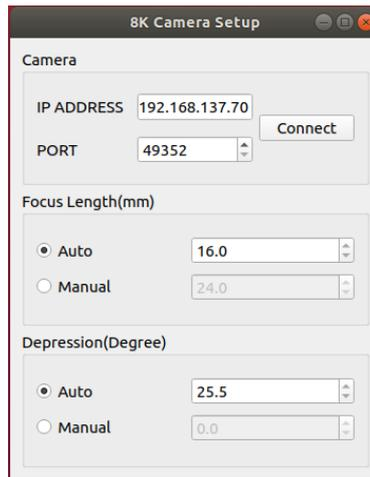
输入 IPU IP 地址和端口号，然后按“连接”按钮。如果连接成功，将显示 Focus Length 和 Depression 的设定值。
