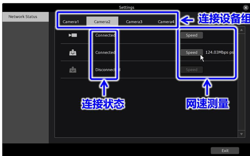
请从连接设备组选项卡中选择想要确认网络连接状态的组。可以确认连接状态，因此请确认显示为“Disconnected”的设备的连接。
