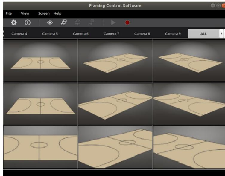
通过“Display Port”选择要在视图画面“ALL”选项卡下显示的相机图像。作为可选择的相机图像 , 将会显示在[连接设备设定](#)中设定的组名。另外 , 最多只能选择在“Display Num”中设定的数量。
