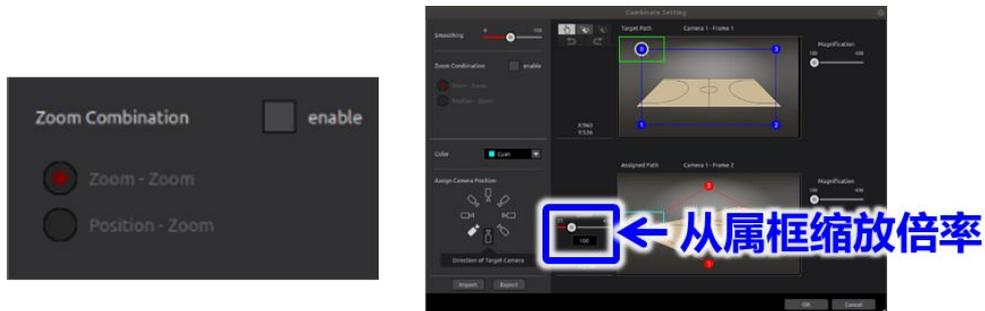
与主框的缩放操作联动并且想使从属框的缩放动作联动时，如下图所示，请勾选“enable”选框，并选择“Zoom - Zoom”。将会显示可设定主框缩放倍率的滑动条、可设定主框为 Zoom In ( 值=400 ) 时的从属框缩放倍率的滑动条、可设定主框为 Zoom Out ( 值=25 ) 时的从属框缩放倍率的滑动条。可以通过操作从属框的滑动条来变更从属框的缩放倍率。请分别设定主框为 Zoom In ( 值=400 ) 时和主框为 Zoom Out ( 值=25 ) 时的从属框缩放倍率。可以通过操作主框的滑动条来变更主框的缩放倍率，同时可以根据从属框的缩放倍率设定值来确认从属框缩放倍率的变化情况。另外，主框的缩放倍率用于动作确认，不会保留。再次打开画面时会恢复成默认值 ( 值=100 ) 。
