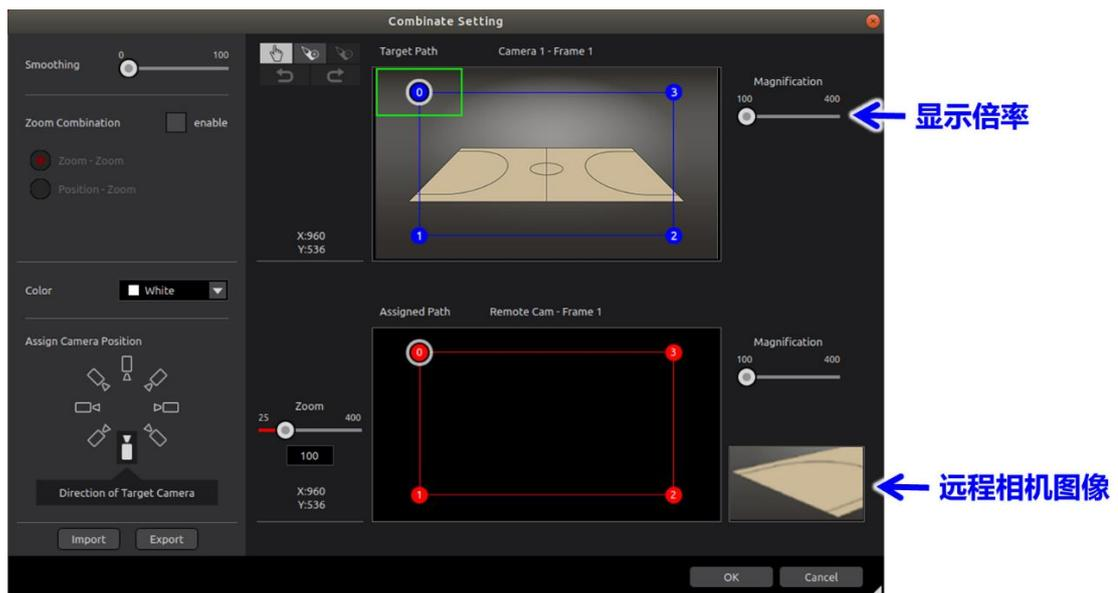
在联动框详情设定画面中，可以设定从属框以及设定与主框联动动作时的对应关系。如下图所示，通过适当更改显示倍率，可以放大显示。
