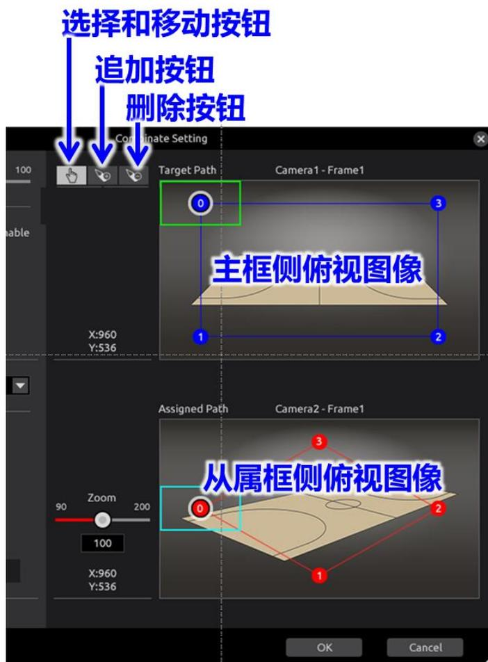
如下图所示，对应点可以移动、追加、删除。另外，如果裁剪区域超出 8K 视角范围，则 CROP 图像中的范围外区域会变成黑色，因此建议您一边确认 CROP 图像一边进行设定。（注意：使用控制器操作时，如果**裁剪框的设定**中可动范围限制设定有效，则移动范围受到限制，使其不能移出 8K 视角范围。在这种情况下，裁剪区域不能平稳运行，因此建议尽可能不要让裁剪区域移动到屏幕的边缘区域。）
