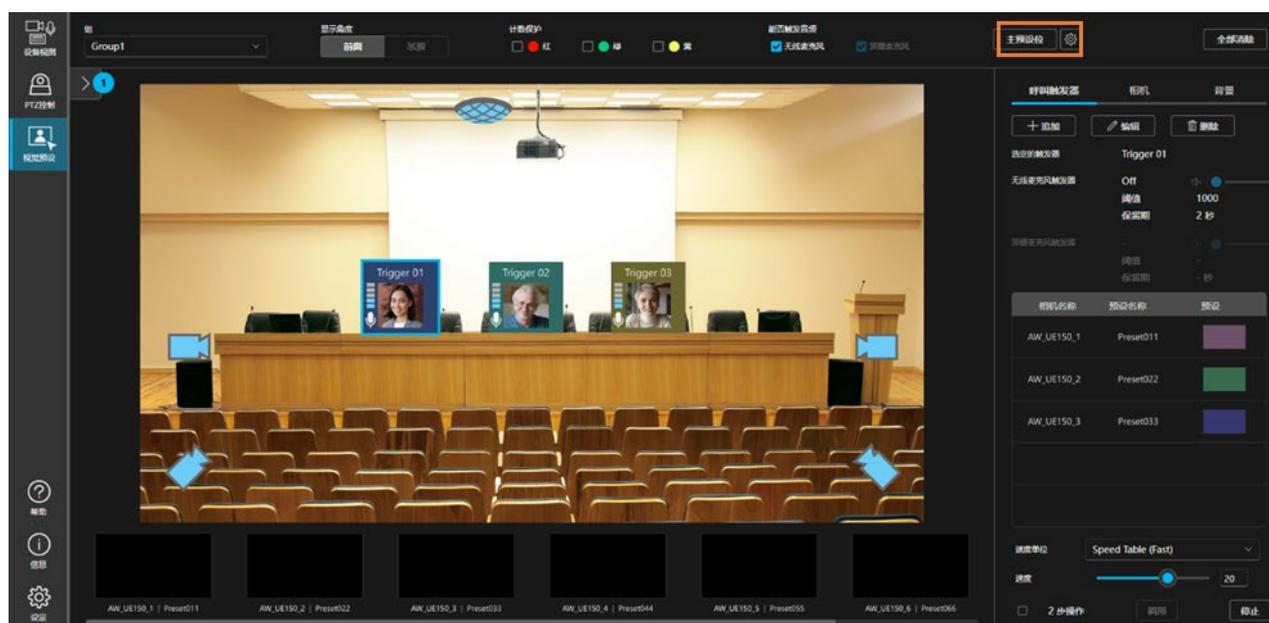
在主预设位的设置中选中[麦克风静音时仍然调用预设]后，麦克风音频不发声的状态（静音状态）已持续一段时间时也会调用主预设位。
